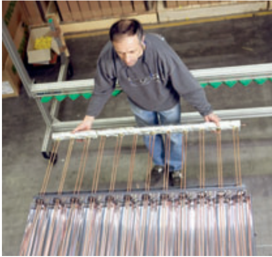
3. Monteren van de collectorbuizen in een vacuümbuiscollector (Ritter Solar/ESTIF).
