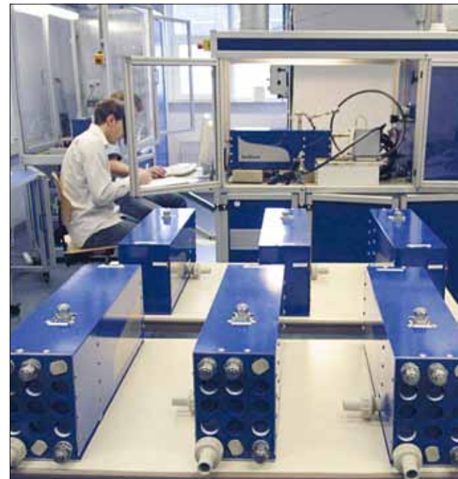
Testopstelling brandstofcellen Bron: NedStack
