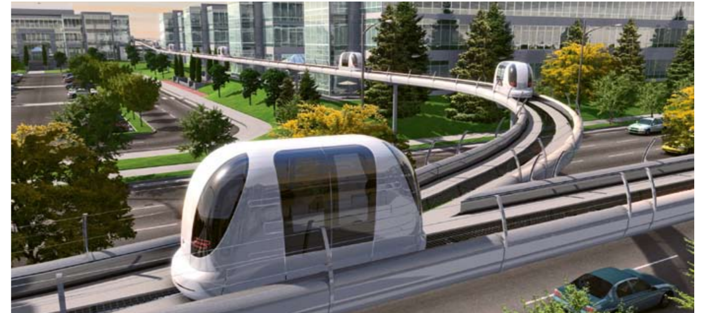
Londen is bezig met een systeem dat ULtra (Urban Light Transport) is gedoopt. ULTRA lijkt op een metro in de zin dat het een eigen “spoor” heeft met vaste “stations” waarop je in- of uitstapt. Maar het werkt met losse auto's die over een gewoon wegdek rijden. De auto rijdt weg zodra je bent ingestapt en zijn er geen tussenstops. 98
