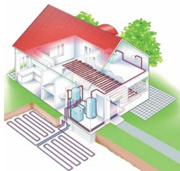
Figuur 1: horizontale bodemwarmtewisselaar
