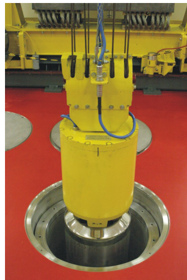
Afbeelding B5.1 en B5.2: Links de HABOG en rechts het insluiten van een cilinder met hoogradioactief afval, bij de COVRA (bron: COVRA)
