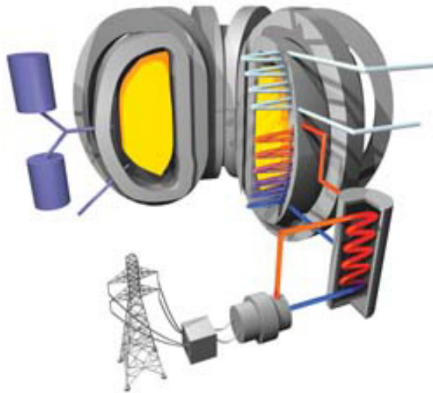
Afbeelding 2: schematische weergave van een kernfusie centrale, het gele gedeelte is het plasma, hier vindt het fuseren plaats (100-150 miljoen °C). (bron: www.fusie-energie.nl )
