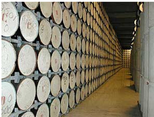
Afbeelding 10: opslag van laag- en middelradioactief afval bij de COVRA in Vlissingen (bron: COVRA)
