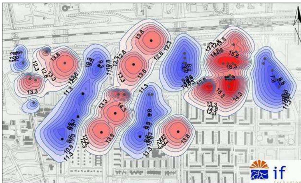
Figuur 3.1 Invloedsgebieden van koude-/warmteopslagsystemen op de Zuidas in Amsterdam met positieve interferentie
